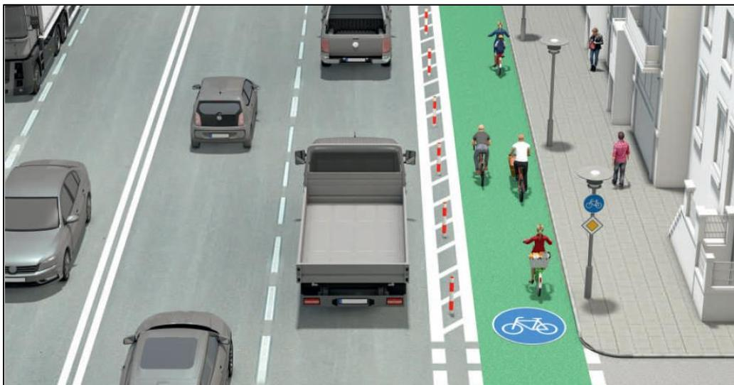
**Abbildung 14:** Prinzipdarstellung Protected Bikelane des ADFC (Quelle: ADFC [1])
